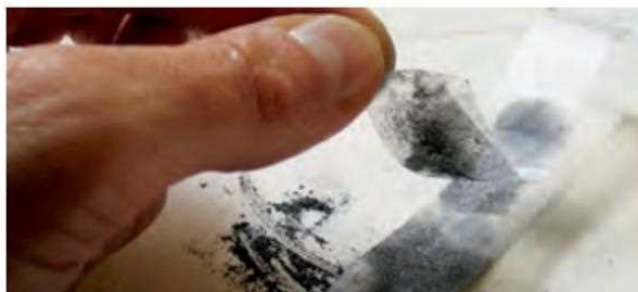
شکل ۴- تهیه گرافن با استفاده از نوار چسب
