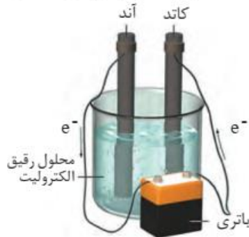
شکل ۱۱- تجزیه آب به گازهای هیدروژن و اکسیژن با مصرف انرژی الکتریکی
