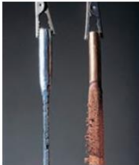
شکل ۸- تغییر جرم تیغه‌ها پس از کار کردن در سلول گالوانی روی-مس.
