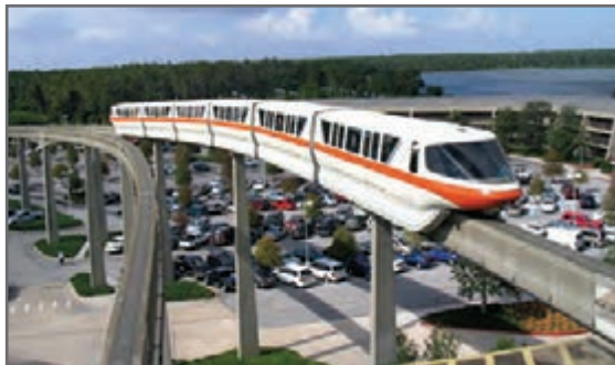
مونوریل، قطار هوایی است که بیشتر در مناطق گردشگری و محوطه‌نمایشگاه‌ها و پارک‌ها کاربرد دارد و هزینه‌ی احداث آن زیاد است؛ وارانگال - هند
