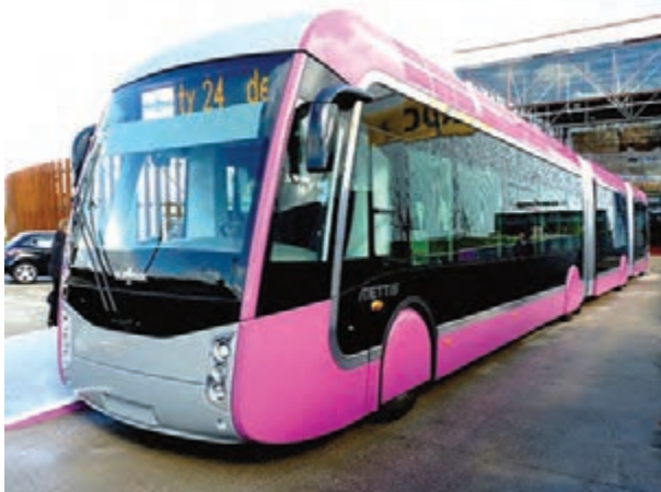
اتوبوس هیبریدی* (دیزل - الکتریکی) فرانسه
