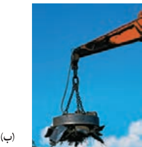
شکل ۳-۲۱ (الف) سیملوله با هسته آهنی. (ب) آهنربای الکتریکی صنعتی
