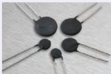
(ب) تصویری از چند ترمیستور دیسکی واقعی
