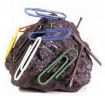
شکل ۳-۱ سنگ آهنربای طبیعی. تالس که اغلب از او به عنوان پدر علم یونان یاد می‌شود، ماده کانی مگنتیت Fe_3O_4 را که ویژگی آهنربایی دارد می‌شناخت.
