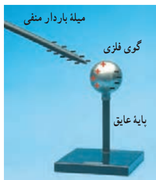
شکل ۱-۲۷ نزدیک کردن میله‌ی باردار منفی به گوی فلزی خنثایی که روی پایه‌ی عایقی قرار گرفته است، موجب ایجاد بارهای القایی مثبت و منفی در دو طرف گوی فلزی می‌شود.
