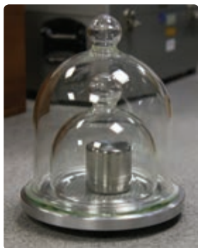
شکل ۱-۷ استاندارد ملی کیلوگرم که نسخه دقیق‌تری از استاندارد بین‌المللی سیور فرانسه است. این نمونه، در مرکز اندازه‌شناسی در سازمان ملی استاندارد ایران نگاه‌داری می‌شود.
