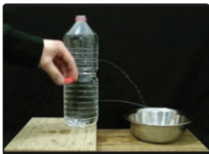
شکل ۱۳-۲ با باز کردن در بطری، آب از سوراخ‌های ایجادشده در بطری، با فشار متفاوت خارج می‌شود. سرعت خروج آب از کدام سوراخ بیشتر است؟
