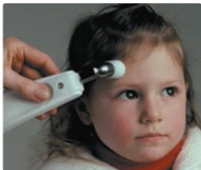
(ب) دماسنج تابشی که بر اساس آشکارسازی شدت تابش گرمایی کار می‌کند.
