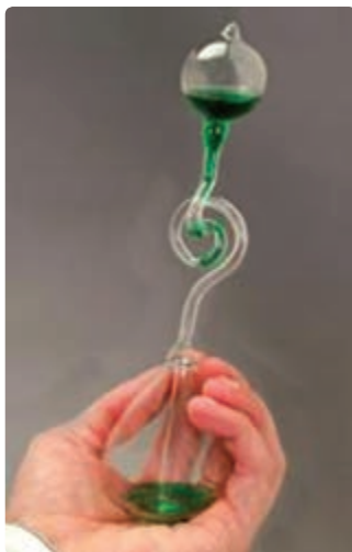
شکل ۴-۳۸ با در دست گرفتن حباب شیشه‌ای و گرم کردن آن، مایع رنگی در لوله ماریچ بالا می‌رود.
